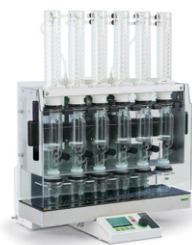
Extraction Unit E-816 SOX & HE Extraction dédiée des graisses
