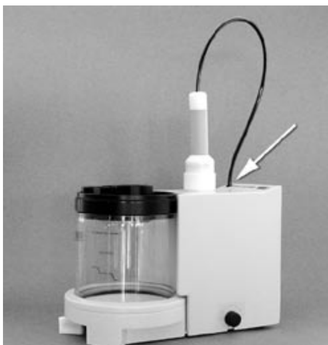
Figura 4.1: Soporte de cartuchos y Cartridger
