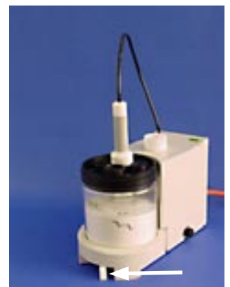
Enroscado del cartucho fija Inmersión en la fase fija Cierre de la válvula de vacío
