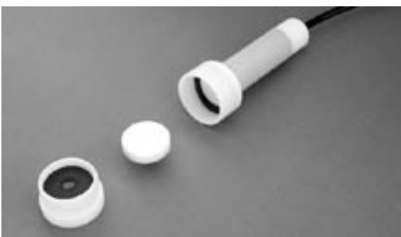
Figura 6.1b: Procedimiento de sustitución de la frita de seguridad
