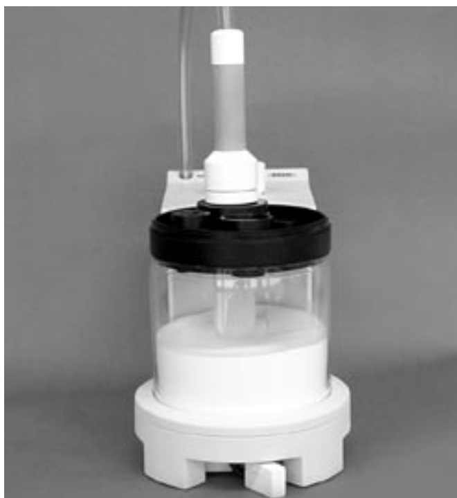
Figura 5.6: Cartucho sumergido con válvula de vacío
