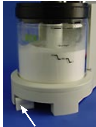
Apertura de la válvula de vacío
