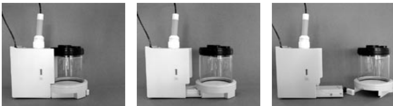
Figura 5.8: Estrazione del recipiente di vetro
