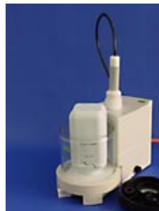
Inserimento del setto poroso superiore.
