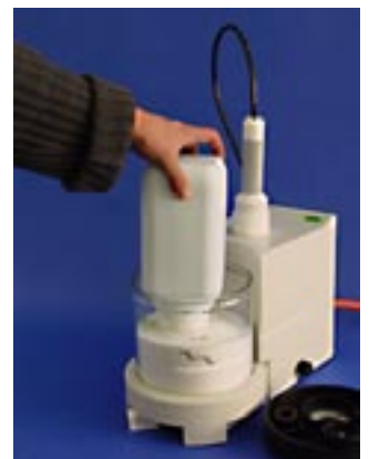
Inserimento del setto poroso superiore.
