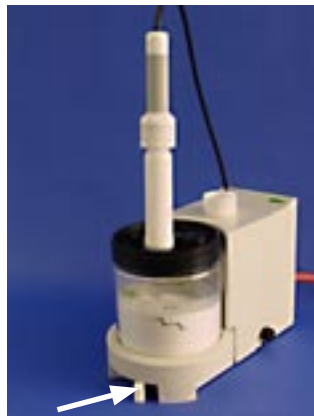
Chiusura dell'estrazione valvola di vuoto
