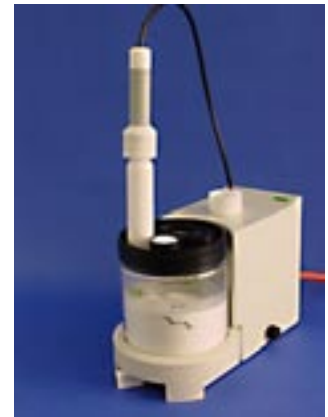
Iniezione della seconda Fritta (superiore). La valvola di vuoto resta aperta
