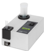
Thiết bị nạp mẫu Sample loader M-569 Nạp mẫu vào cột mao quản hiệu quả
