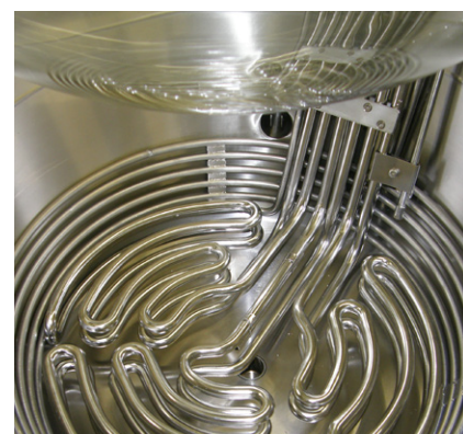
Applicazioni speciali (per esempio bobina di raffreddamento per il bagno)
